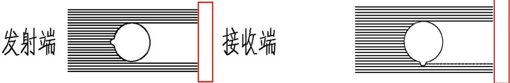
图示1轴的盲区，凸点不良在左侧盲区      图示1轴的盲区，凸点不良在下侧检测边缘
